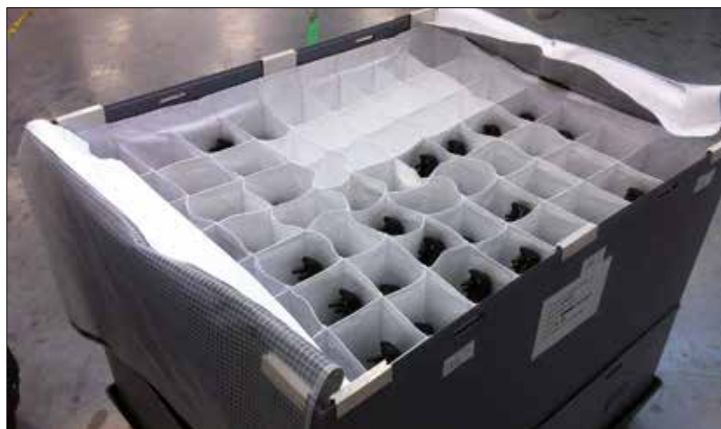
Genähte Einteilung aus Stoff mit halbtransparenten Abdeckklappen.
