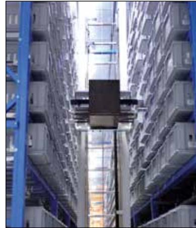
**E-LINE-Behälter in einem automatisierten Lager. Sonderausführung: Schlitzperforation für bessere Kühlung und Leistung der Sprinkleranlage. Verstärkte Böden für eine garantierte Belastbarkeit von 50 kg ohne Durchbiegen. (Foto: Vanderlande Industries.)**
