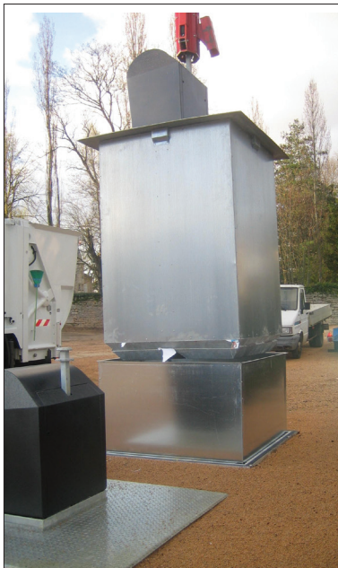
Sobald der Container angehoben wird, ist die Sicherheitsvorkehrung zu sehen.
