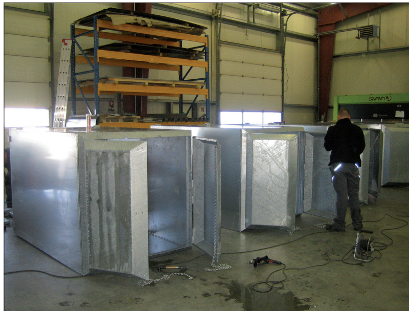
Montieren der Bodenklappen.
