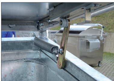
Der Deckel bleibt durch die Federmechanik offen.
