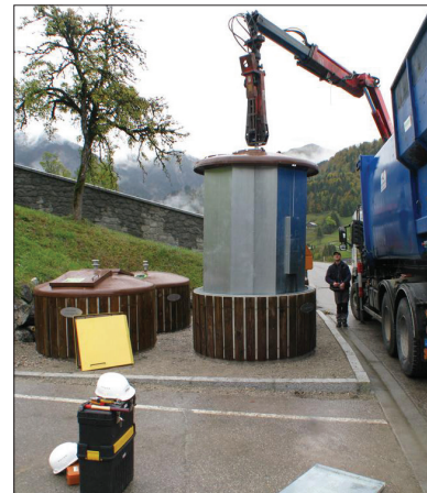
Tièrso-System während der Entleerung
