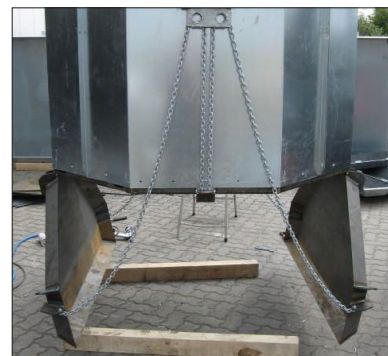
Doppelte Bodenklappe, die kontrolliert geöffnet werden kann. Im Inneren des Containers mit doppelter Klappe befinden sich keine beweglichen Teile des Bedienungssystems.
