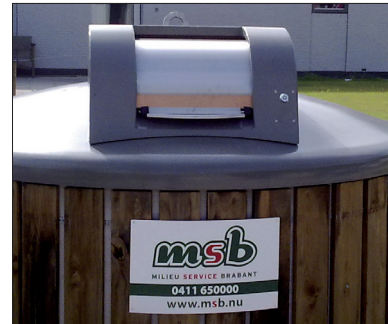
TiÈrso mit abschließbarer Trommel in Vught (Niederlande). Das Zylinderschloss ist mit dem zum Wohnkomplex identisch.
