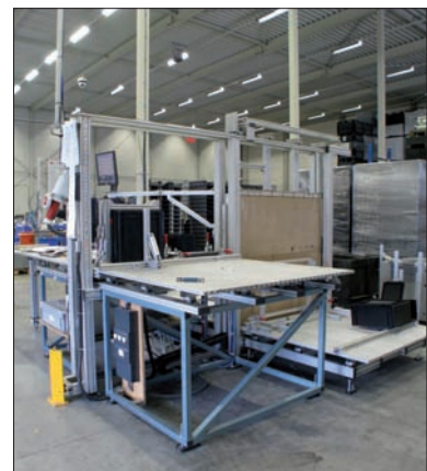
Spiegellasmachine voor het lassen van kunststof producten tot 1200 mm.
