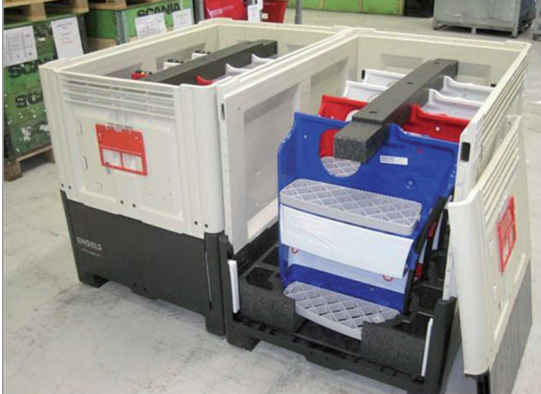
Opvouwbare 'hygiënische' palletbox met uitneembare wand.
