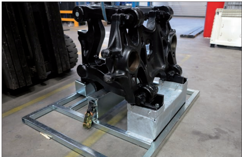
Een volledig uit staal vervaardigde productdrager voor een onderdeel van een landbouwvoertuig. De productdrager is passend gemaakt voor gebruik in combinatie met een Smartbox.
