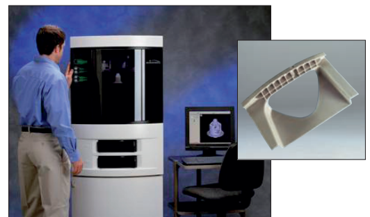
Vaak wordt ervoor gekozen een 'één op één' model te vervaardigen, een kostbare procedure. Gelukkig is, via CAD programma's aan te sturen 3D printers, een voorbeeld nu eenvoudig in enkele uren te vervaardigen.
