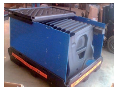
Pallets met Aircell opzetwan-den en deksels in combinatie met een schuiminterieur om automotive onderdelen op hun plaats te houden.
